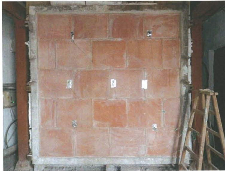
圖 22 測試 195min 後試件背火面
