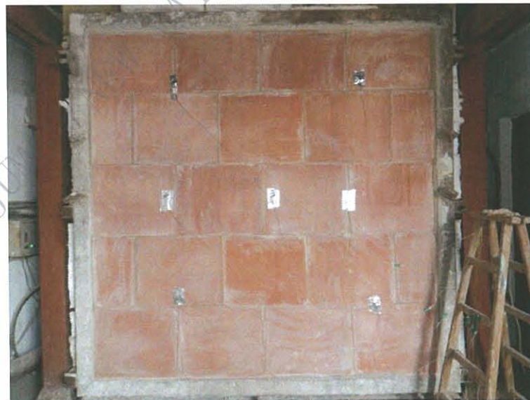
圖 23 測試 210min 後試件背火面
