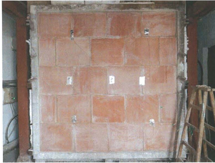
圖 16 測試 105min 後試件背火面
