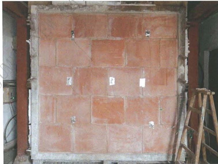
圖 17 測試 120min 後試件背火面
