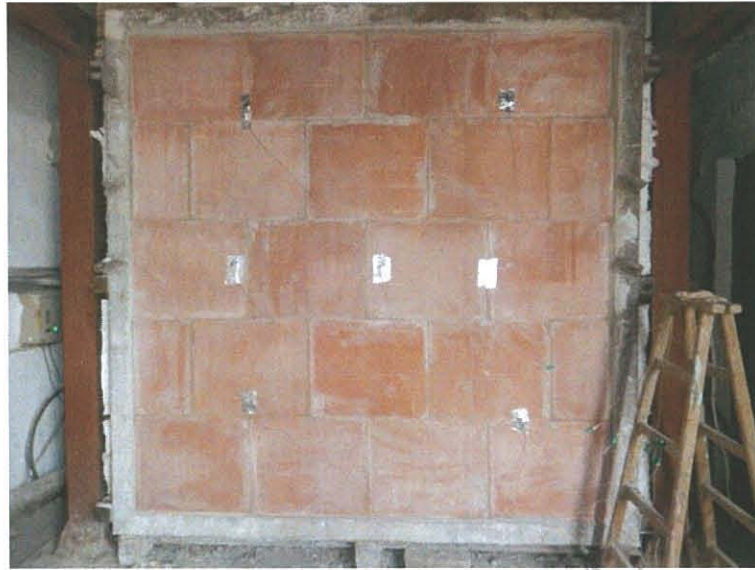
圖 18 測試 135min 後試件背火面
