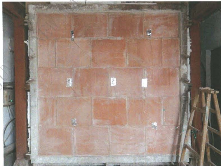
圖 21 測試 180min 後試件背火面
