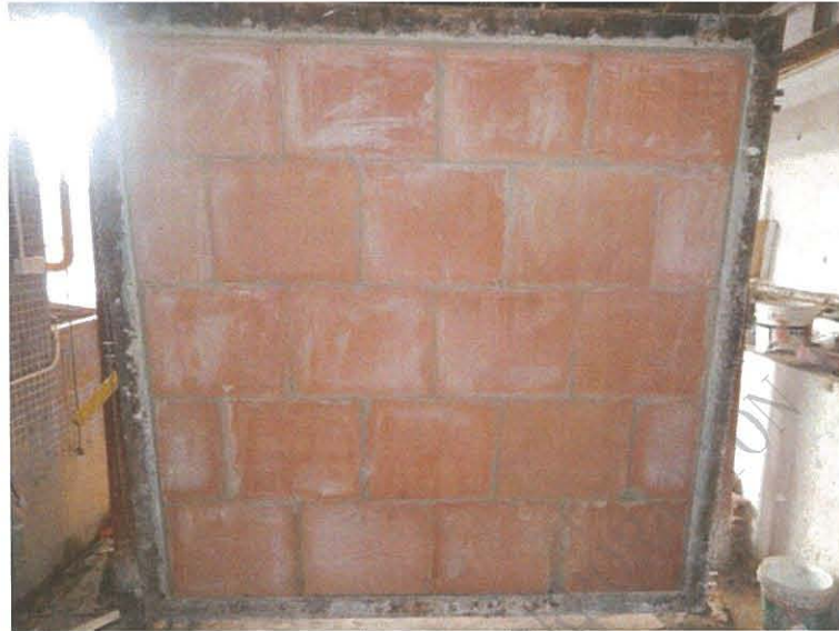
圖 8 測試前試件向火面
