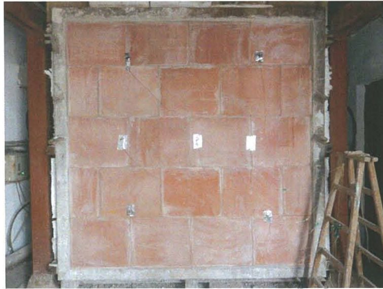
圖 20 測試 165min 後試件背火面
