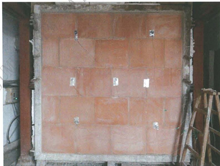
圖 11 測試 30min 試件背火面
