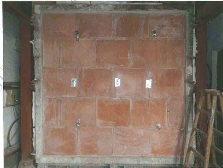
圖 25 測試 240min 後試件背火面
