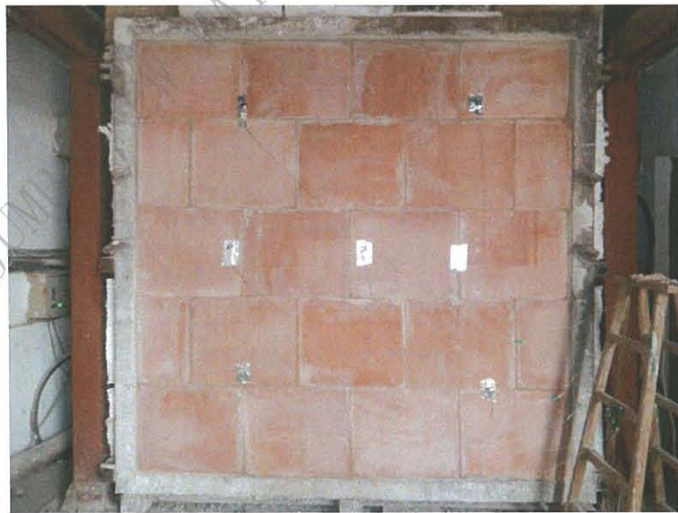
圖 15 測試 90min 後試件背火面
