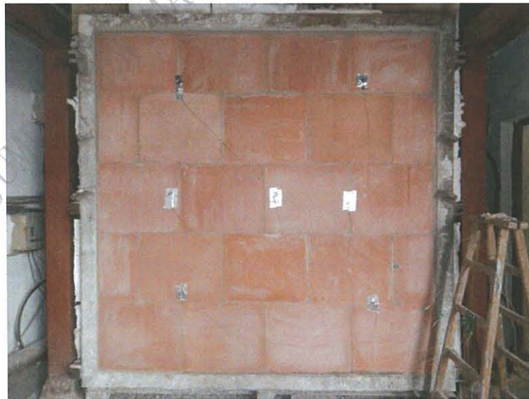
圖 9 測試前試件背火面
