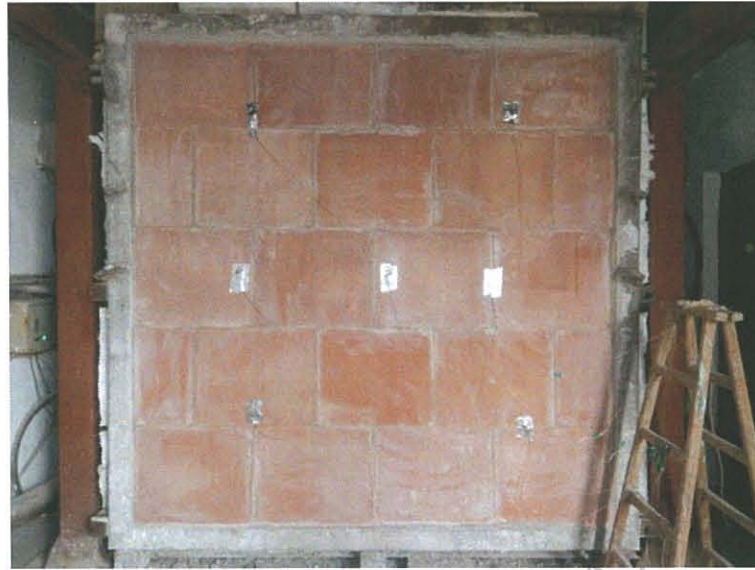
圖 24 測試 225min 後試件背火面
