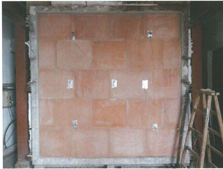
圖 10 測試 15min 試件背火面
