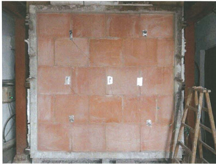
圖 12 測試 45min 試件背火面
