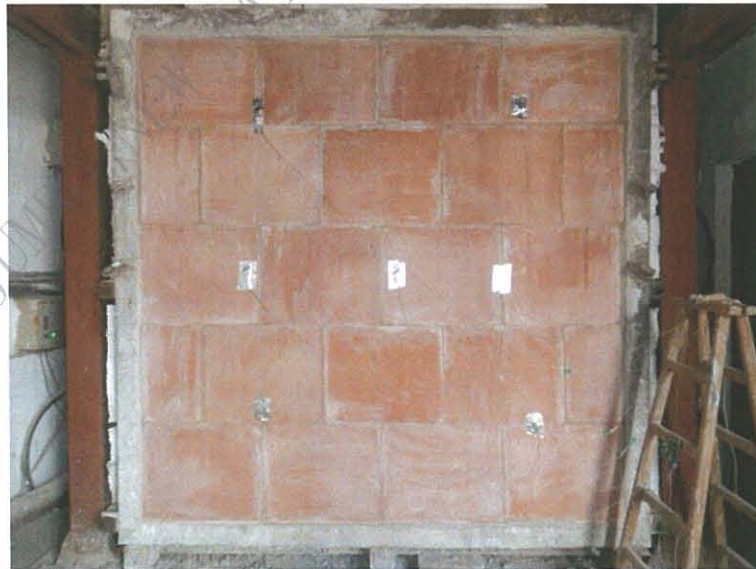
圖 19 測試 150min 後試件背火面
