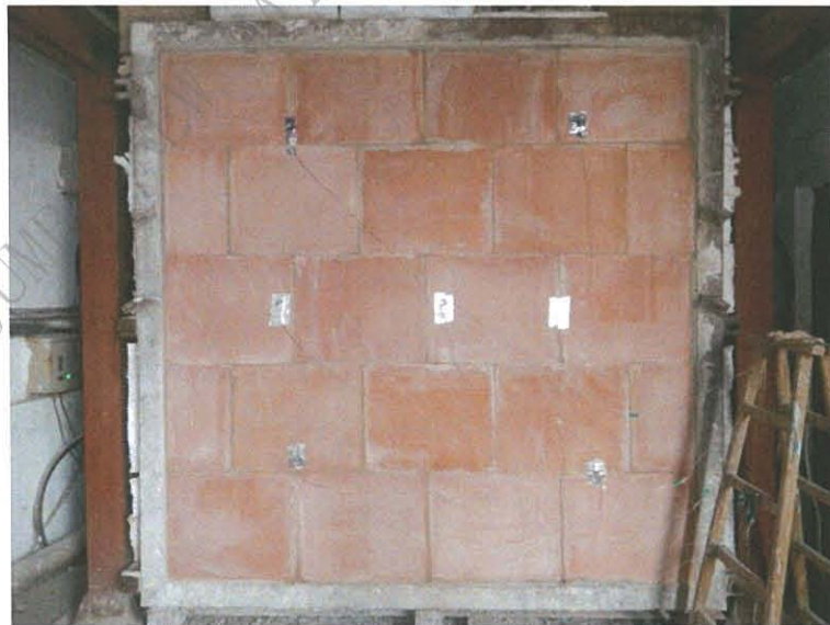
圖 13 測試 60min 後試件背火面
