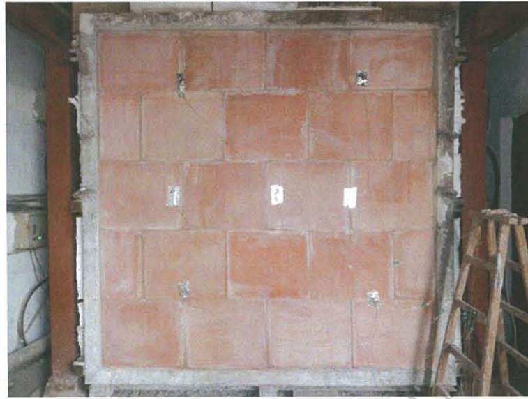
圖 14 測試 75min 後試件背火面
