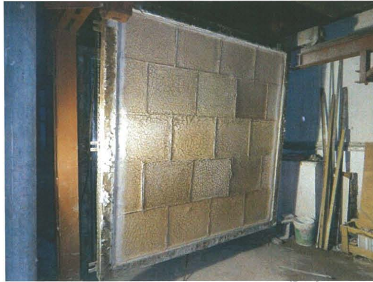
圖 26 測試後試件向火面
